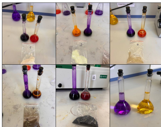
Рисунок 3. Этап введения энтеросорбентов в концентрированные растворы индикаторов. Figure 3. Stage of introduction of enterosorbents into concentrated solutions of indicators.
