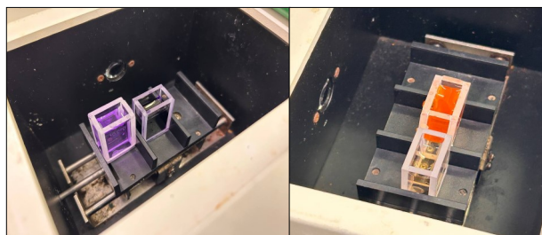
Рисунок 4. Спектрофотометрия с использованием различных индикаторов. Figure 4. Spectrophotometry using various indicators.
