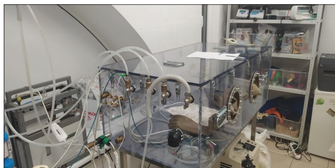
Рисунок 1. Камера газовая экспериментальная лабораторная (КГЭЛ-1). Figure 1. Experimental laboratory gas chamber (KGEL-1).
